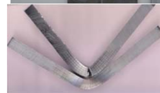
Рис. 1. Диаграммы пластичности сталей У12, У8 и титанового сплава ВТ6 (а) и испытанные образцы (б)
